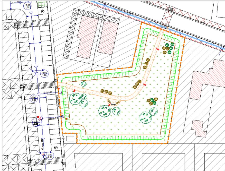
Figura 23: planimetria sistema di invaso tramite area a verde ribassata
