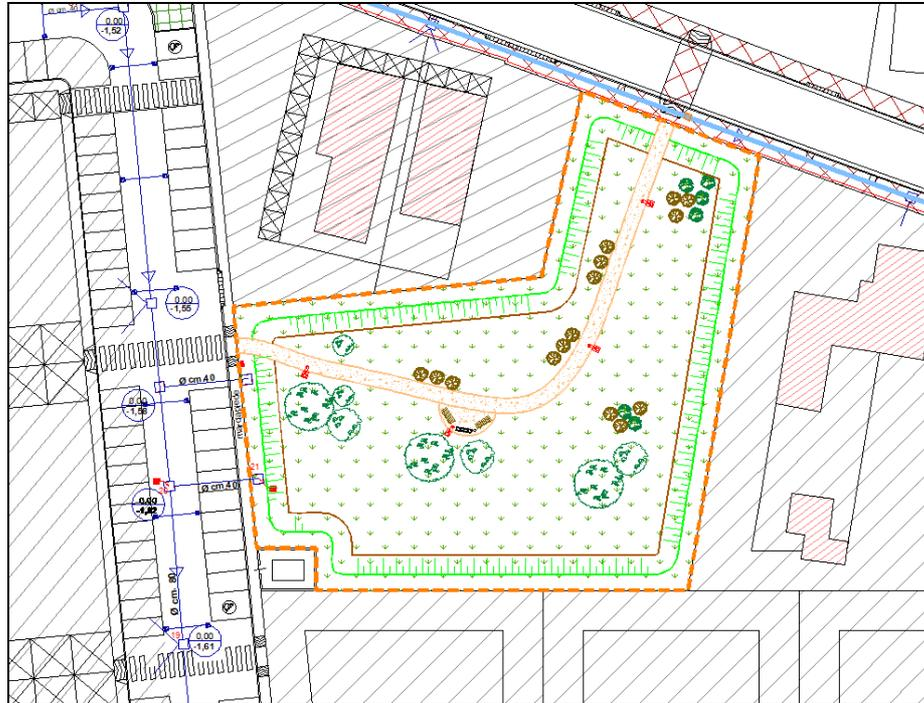
Figura 12: planimetria sistema di invaso tramite area a verde ribassata
